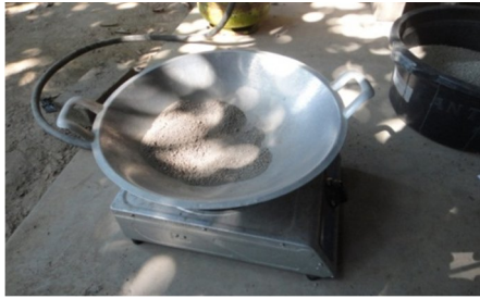
Gambar 6. Proses Pengeringan Lumpur Lapindo Menggunakan Kompor Gas (Sumber: Dokumentasi Tim Peneliti, 2015)
