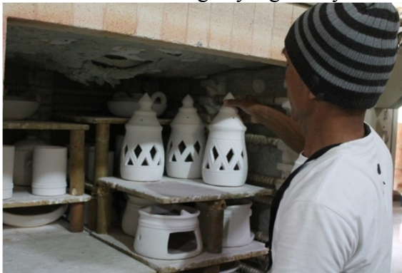
Gambar 11. Benda Keramik yang Telah Ditata dalam Tungku Bakar (Sumber: Dokumentasi Tim Peneliti, 2015)
