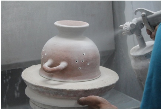
Gambar 10. Proses Pengglasiran Keramik dengan Teknik Semprot (Sumber: Dokumentasi Tim Peneliti, 2015)
