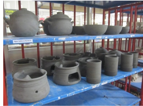
Gambar 8. Proses Pengeringan Benda Kerja dengan Cara Diangin-anginkan (Sumber: Dokumentasi Tim Peneliti, 2015)
