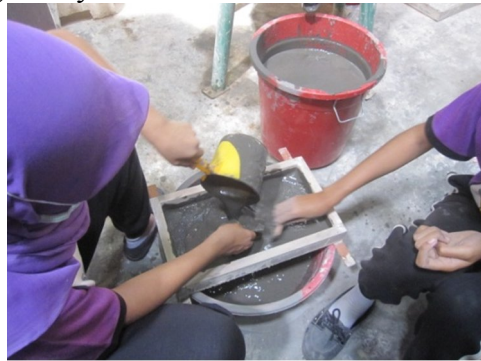
Gambar 5. Proses Penyaringan Lumpur Lapindo (Sumber: Dokumentasi Tim Peneliti, 2015)
