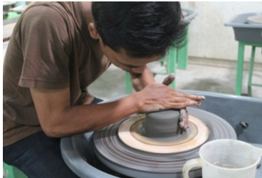
Gambar 7. Proses Centering dalam Teknik Putar Centering (Sumber: Dokumentasi Tim Peneliti, 2015)
